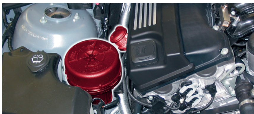
BMW E46 内的二次进气阀和二次空气泵（高亮显示）
