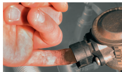
在 BMW 520i 二次进气阀中“用手指试验”（高亮显示）若在该侧存在沉积物，则止回阀不密封，必须予以更换。
