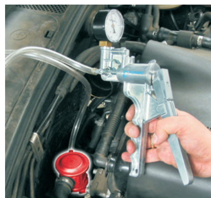
利用手动真空泵检查二次进气阀
